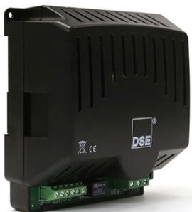
El cargador de batería mantiene la carga suficiente en la batería para arrancar el equipo cuando se requiera, aunque no se esté utilizando el equipo. Estos cargadores están diseñados para estar permanentemente conectados a las baterías, manteniéndolas cargadas a su máxima capacidad.
